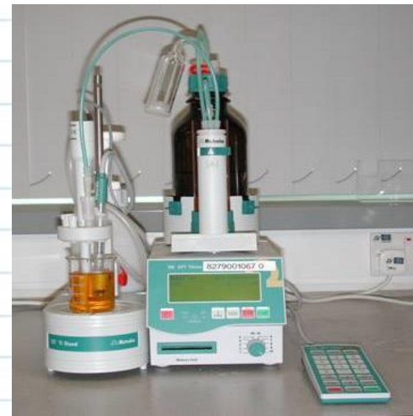
รูป 6 เครื่อง 799 GPT Metrohm Titrino titrator สำหรับหาค่า pK
