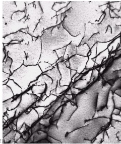
ภาพจาก TEM แสดงความบกพร่องแบบเส้นที่เกิดขึ้นใน ผลึกโลหะไทเทเนียมผสม
